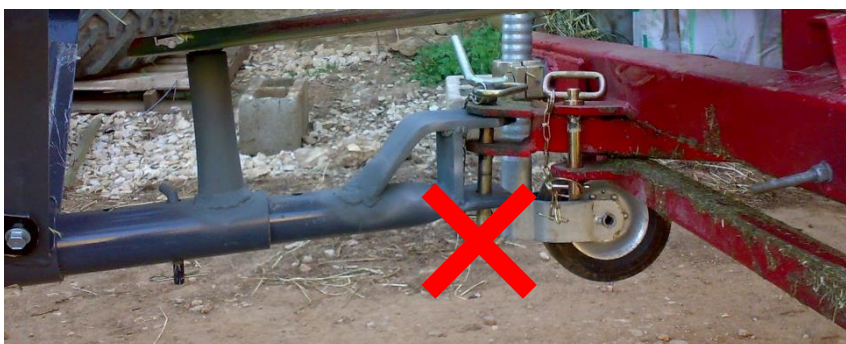
Figur 3 Brug aldrig en lang bolt som kobler to gafler sammen
